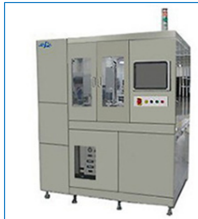
Нанесение фоторезиста ELS 3606FA
