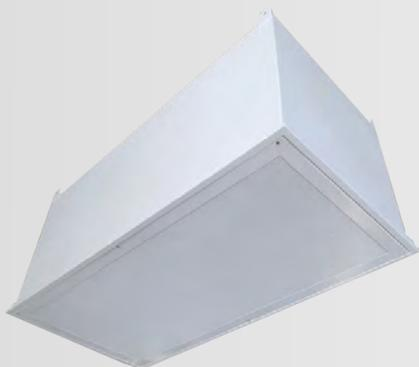
Фильтровентиляционные модули (ФВМ) – это элемент вентиляционной системы помещения. Служит для подачи высокоочищенного воздуха и создания однонаправленного равномерного (ламинарного) потока воздуха в чистом помещении. ФВМ необходим для создания класса чистоты ИСО 5 и выше.
