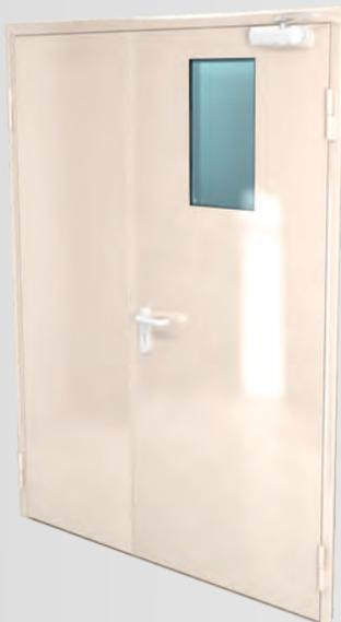
Полотно и коробка покрыты специальной порошковой краской стойкой к дезинфицирующим средствам и УФ-излучению. По периметру дверей проложено два контура уплотнения против холодного дыма и терморасширяющаяся лента на графитовой основе против горячего дыма.
