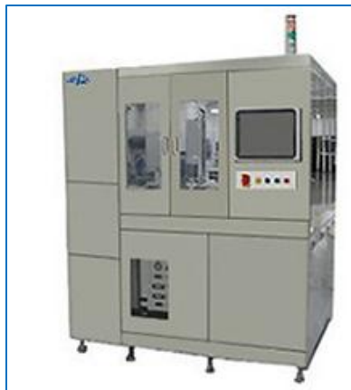
Нанесение фоторезиста ELS 3606FA
