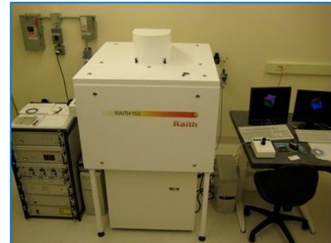
Электронный литограф Raith-150
