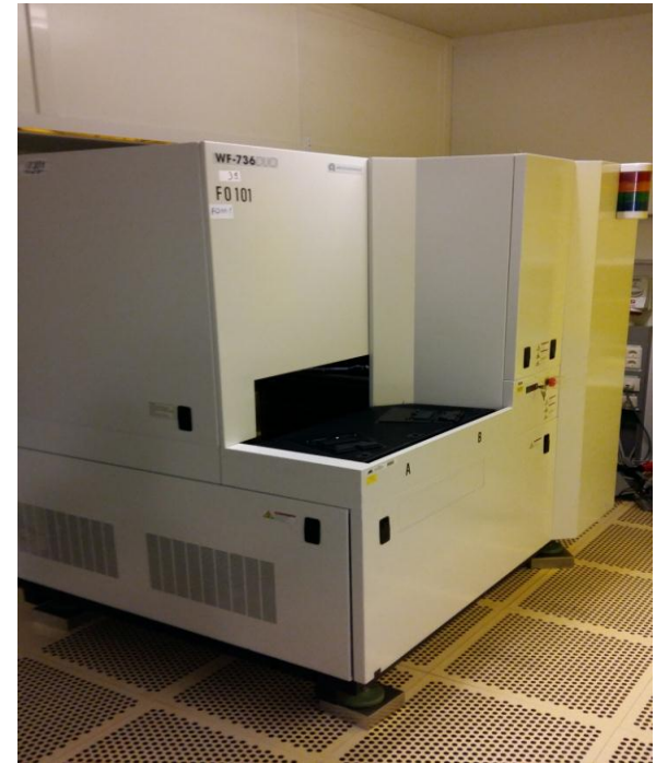
Установка автоматической инспекции пластин АМАТ WF-736DUO.
