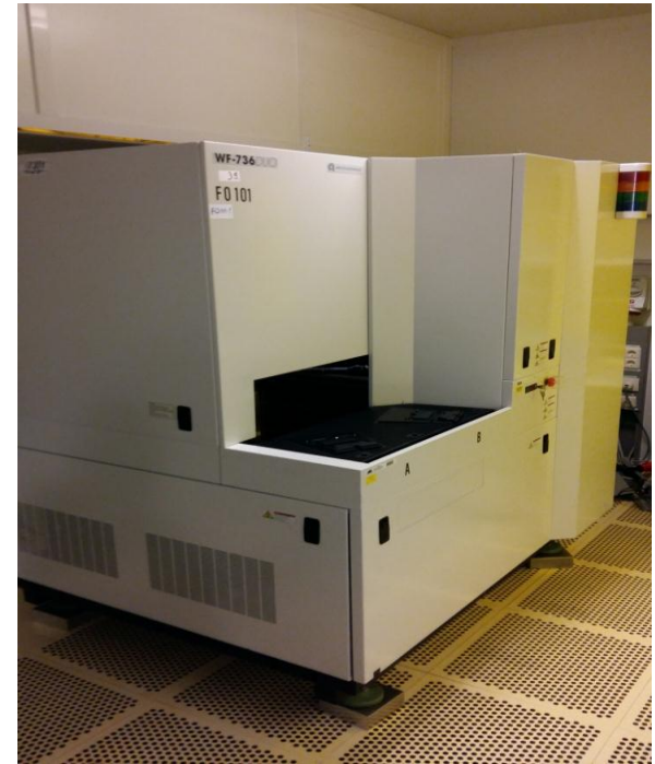
Установка автоматической инспекции пластин АМАТ WF-736DUO.
