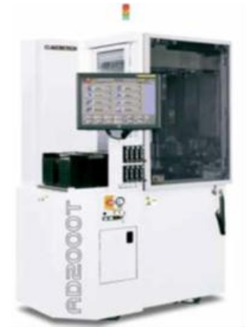
Установка дисковой резки AD2000S компании Accretech (Япония).
