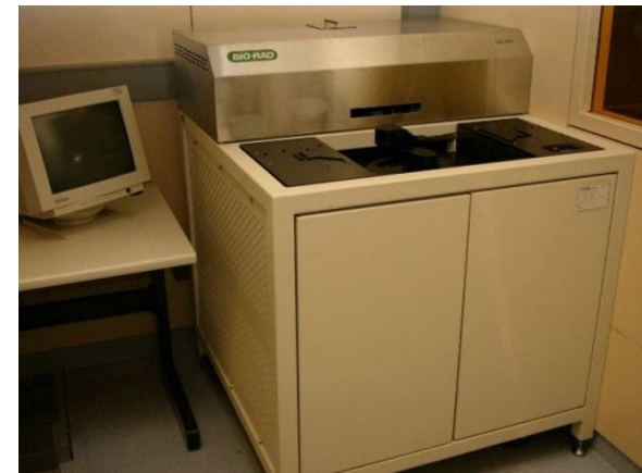
ИК Фурье-спектрометра QS 500. BIO-RAD (США).
