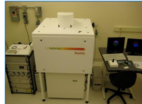
Электронный литограф Raith-150
