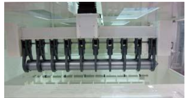
Автоматическая система жидкостной химической обработки пластин Tetreon Technologies
