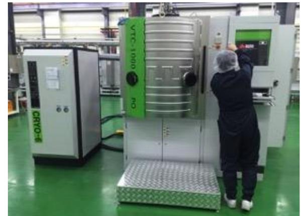
Сборка и тестирование оборудования на фабрике VAC-TEC в Кореи. Установка электронно-лучевого напыления АОП и металлизации, тип VTC-1350-CP/DP
