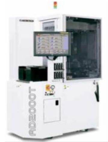
Установка дисковой резки
