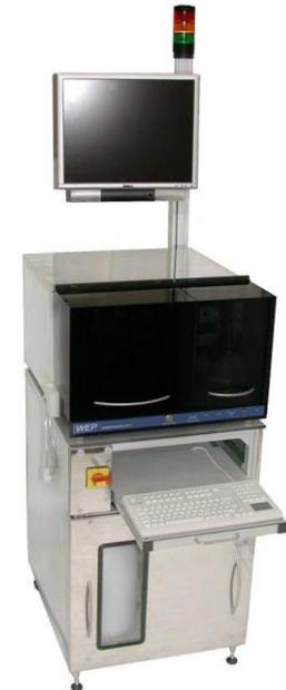
Электрохимический с-в профилметр CVP21KLA. WEP (Германия)
