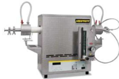
Печь отжига кремниевых пластин производства компании Nabertherm GmbH.
