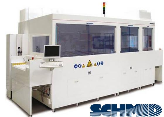
**ПРЕДОЧИСТКА – ТЕКСТУРИРОВАНИЕ – ТРАВЛЕНИЕ – ОЧИСТКА – ПРОМЫВКА - СУШКА**
