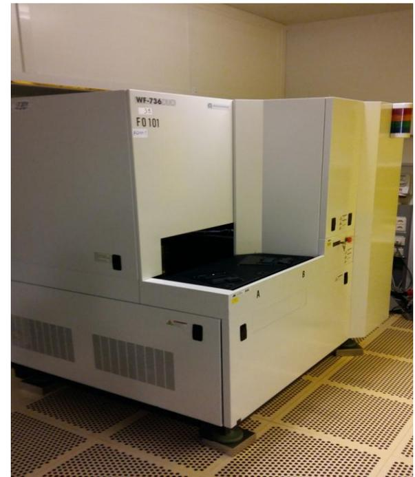
Установка автоматической инспекции пластин АМАТ WF-736DUO.
